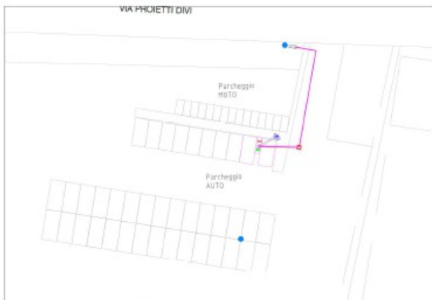
Pianta infrastruttura di ricarica n. 03 - scala 1:200
