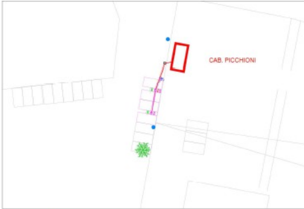
Pianta infrastruttura di ricarica n. 26 - scala 1:200
