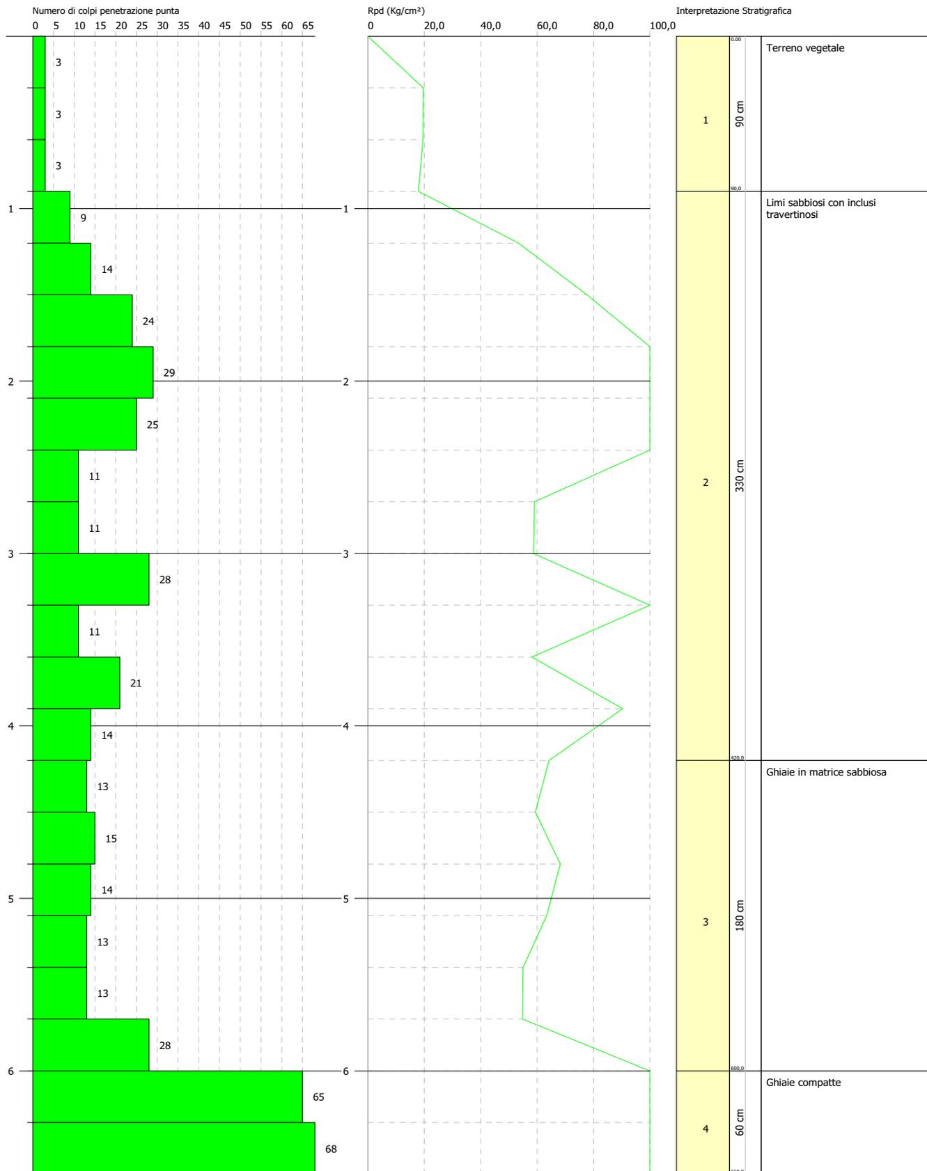
**PROVA PENETROMETRICA DINAMICA Nr.2**
