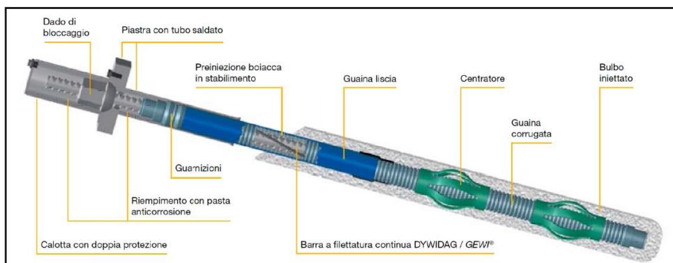
**Figura 8. Particolare delle barre tipo Dywidag**
