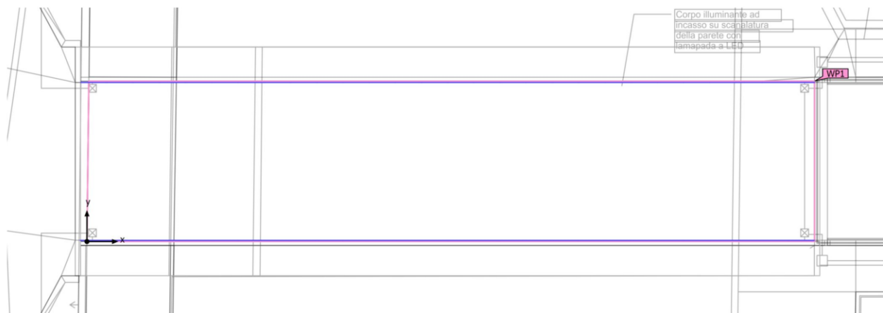
Figura 12 – Schema illuminazione interna al sottopasso.
