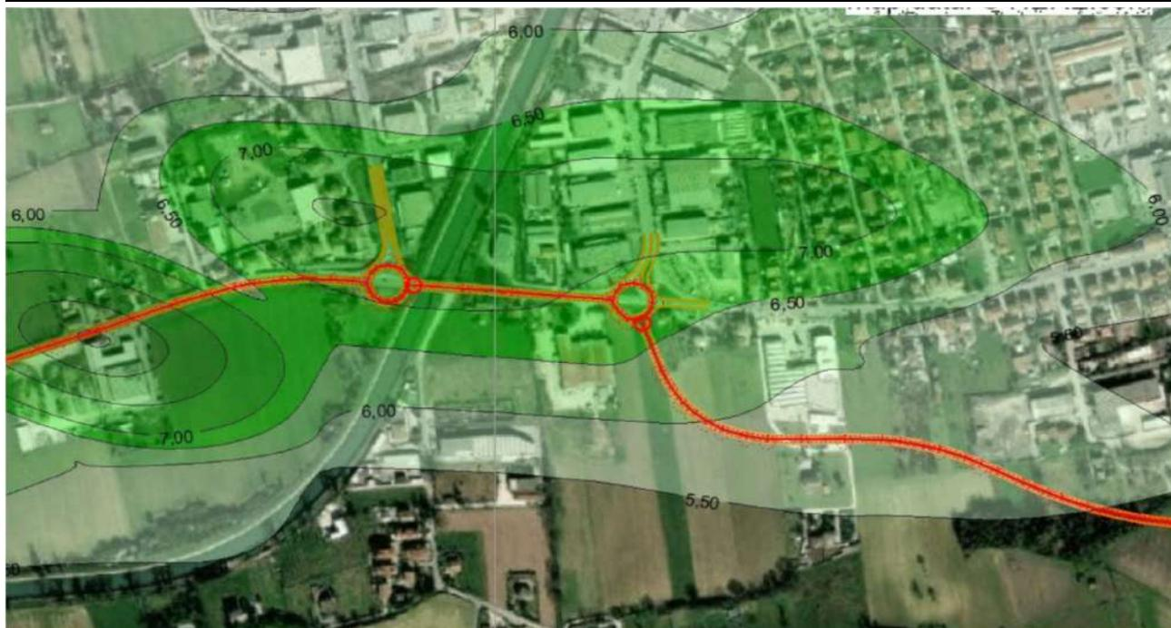
Figura 46 – Modellazione 3D inquinante PM10 su base 24 ore – zona Via Narni
